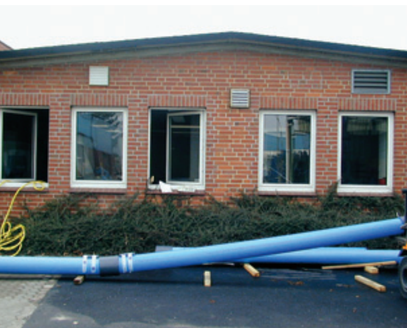
Abb. 1 Neben den Laborversuchen wurden Durchbiegungen einer herstellerspezifischen Rohrverbindung bestimmt.
