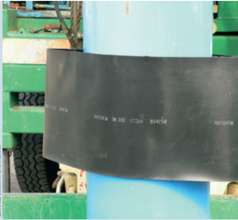
◁ Abb. 2 Klassische Rohrverbindung nach DIN 4925
